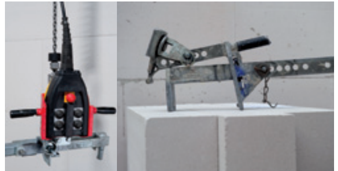
Einmann-Steuerung, Quergreifer für Passteine
