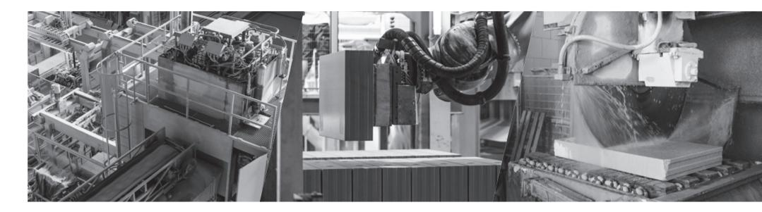
Durch die schwere Stahltür zur Produktion betritt man eine andere Welt. Es ist warm, es ist laut – große Maschinen aus Stahl arbeiten präzise im Takt. Computergesteuert. Woher kommt die Hitze? Diese hat viele Quellen. In großen Mischern werden nach vorgegebenen Rezepturen ungelöschter Kalk, Sand und Wasser miteinander vermengt,
