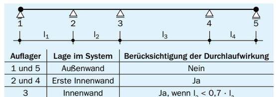
Bild 3/2: Ermittlung der Deckenauflegerkräfte bei einachsiger gespannten Decken
