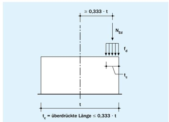
Bild 6/2: Ausmitte der Bemessungslast bei Aufnahme durch den Spannungsblock
